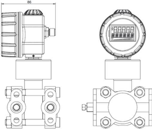
Тип 403022/0-0-2 (длинный корпус, нержавеющая сталь, с кабельным вводом)
